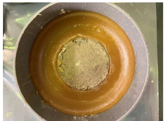
写真-1 パラフィンで覆われた上端の様子
