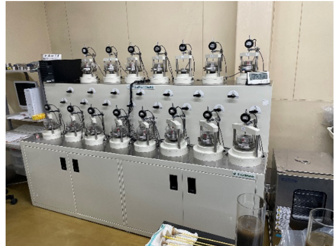
(協)土質屋北陸の空圧式全自動圧密試験機
