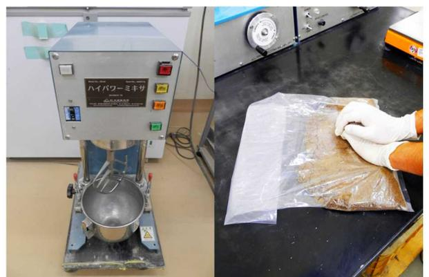
写真-1 機械練りによる混合 写真-2 手練りによる混合
