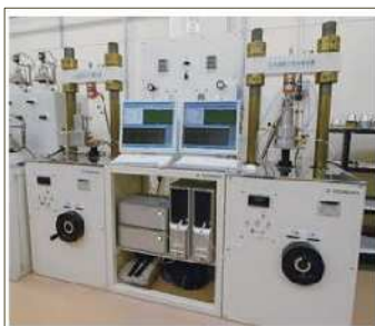
■定ひずみ圧密試験機（JIS A 1227, JGS 0412）
