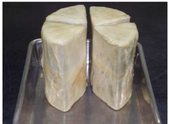
写真-6 パラフィン施工状況
