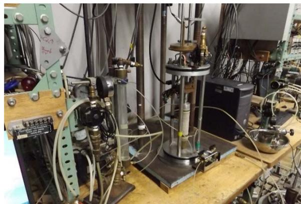
写真 4 試験室の三軸圧縮試験機
