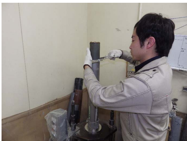
土質試験の始まりは抜出・観察作業からスタート
