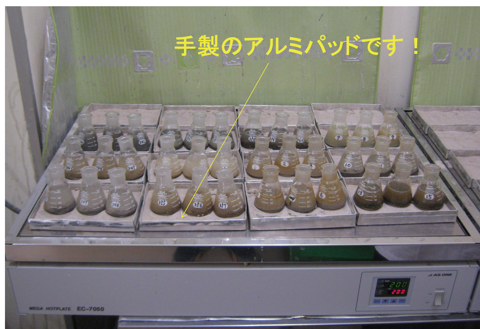
p-1 メガホットプレートと手製のアルミバット (三角フラスコ型比重瓶) p-2三角フラスコ型比重瓶と従来型比重瓶
