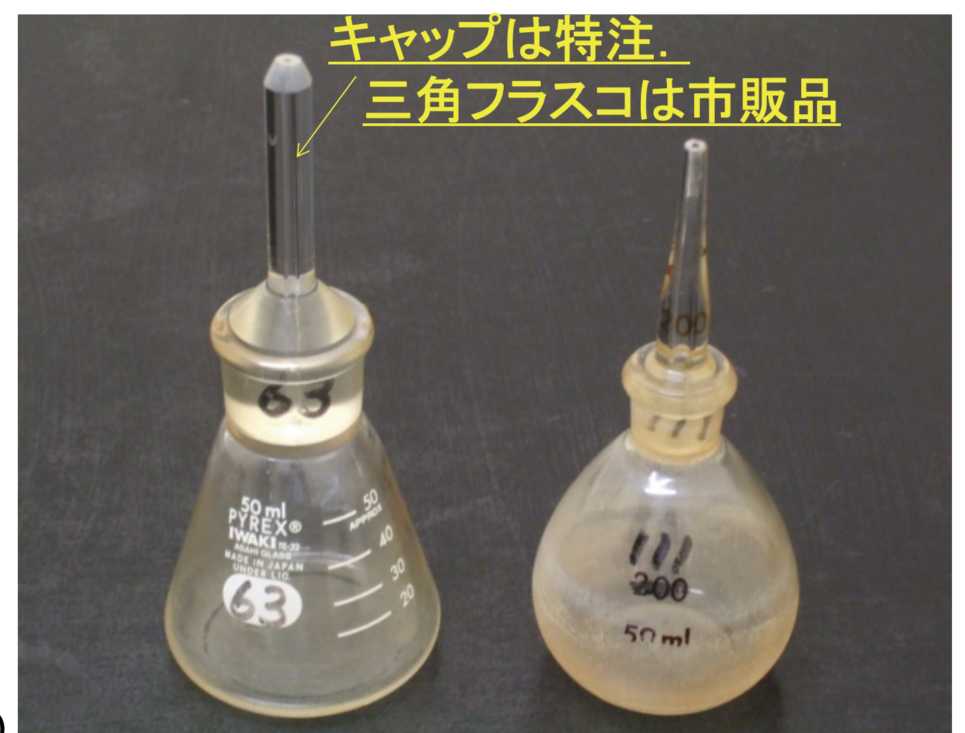
p-1 メガホットプレートと手製のアルミバット (三角フラスコ型比重瓶) p-2三角フラスコ型比重瓶と従来型比重瓶
