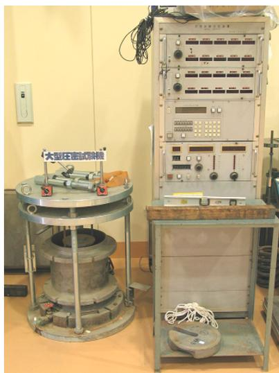
写真-1 大型圧密試験機と計測システム
