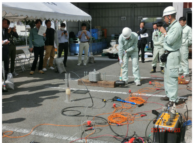
(PS 検層の実演: S 波, ダウンホール法) (内容: ボーリング孔内での固定方法をアクリル管内で再現)
