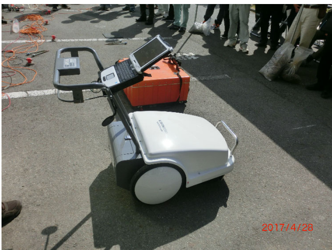
(このシリーズで初めて登場の地下レーダー探査) (NIPPONSIGNAL GROUNDSEER GN-01 (探査深度: 標準 GL-1.5m))
