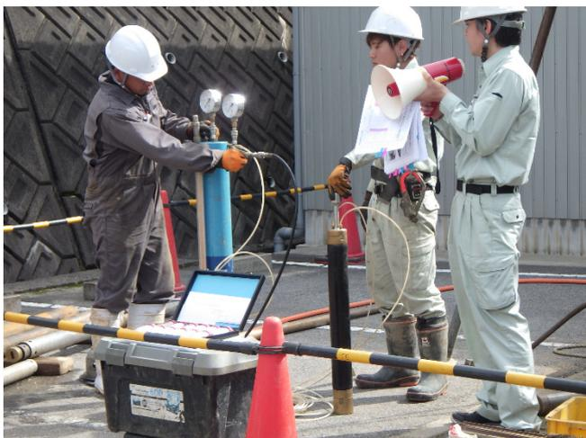
(原位置試験-孔内水平載荷試験-)
