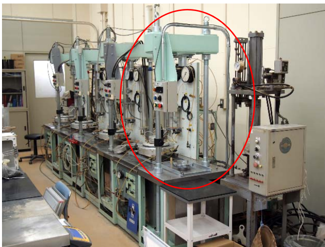
写真-3.5 中型三軸試験機(今期は手前の載荷枠増設→4 連化完成)
