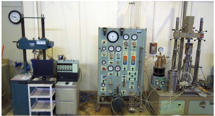
写真-3.3 中容量三軸試験機の独立化完成 (配置は今後, 材料試験設備と調整)
