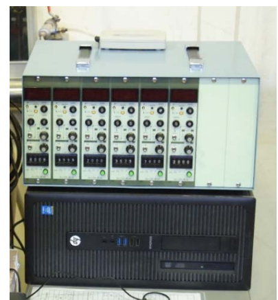
写真-3.4 DV 付き増幅器(KA-700) \times 6 台 + 計測用コンピュータ hp
