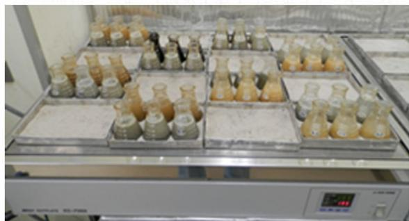
写真-1 ホットプレート法による気泡の除去状況
