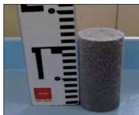
写真-3 成形後の試料 (端面成形前)
