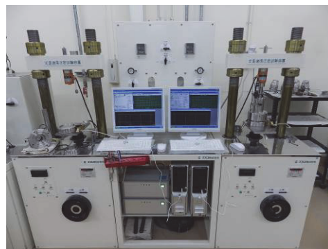
図2 定ひずみ圧密試験装置
