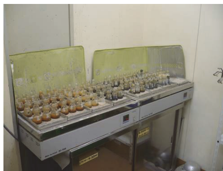
図4 大型ホットプレートによる加熱状況
