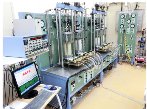
(新設した静的～動的三軸試験機：ニューマークD法対応)
