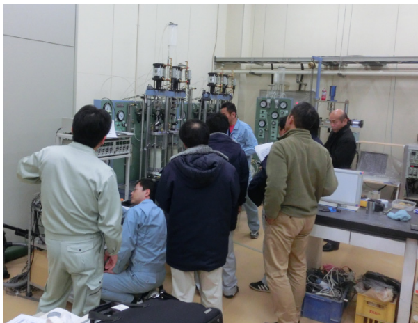
(繰返し三軸+単調載荷試験の見学, 供試体 \phi=10\text{cm} )
