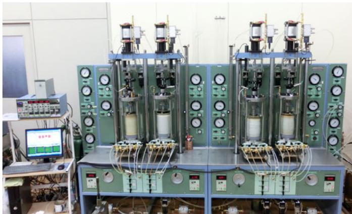
今回導入した試験機により、詳細ニューマーク D 法に対しても、供試体径  $\phi$  =10cm まで対応可能となり、試験範囲が広くなりフル稼働中です。主な特徴は以下の通りです。
