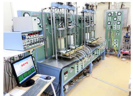
（新設した静的～動的三軸試験機：ニューマークD法対応）
