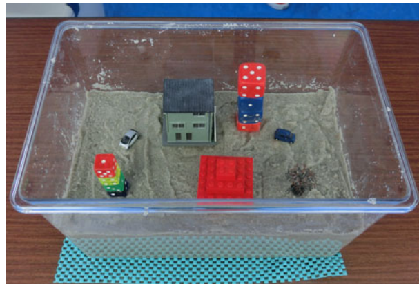
(液状化モデル：振動を加えて、マンホールの浮上を再現)
