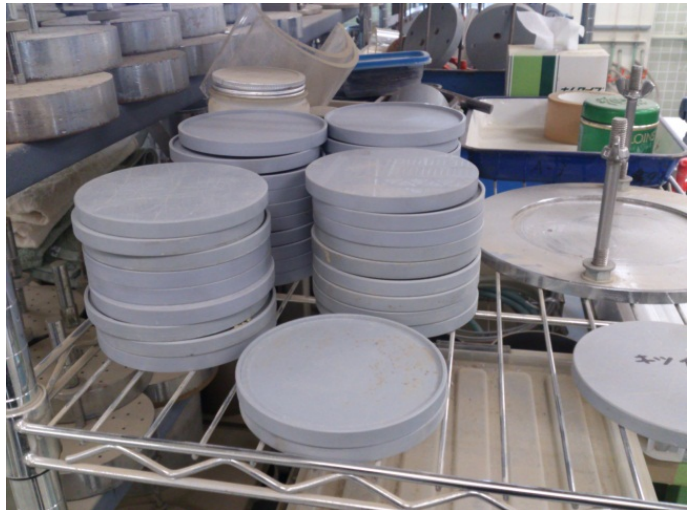
写真-1 養生用の塩ビ製底盤
