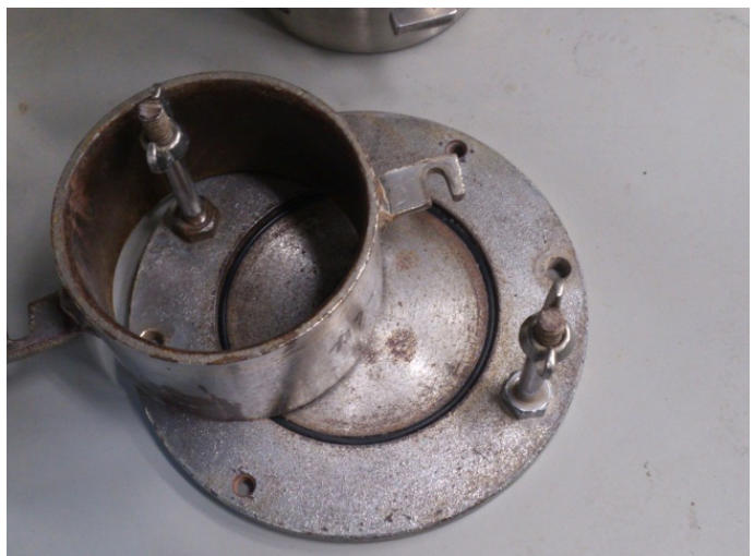
写真-2 締固め試験用のモールド底盤
