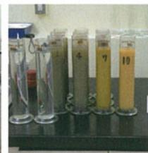
粒度試験-沈降試験
