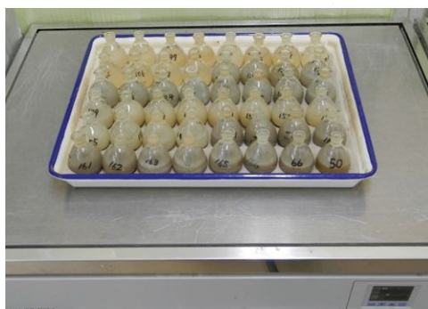
写真-2 大型ホットプレートによる煮沸の試験状況
