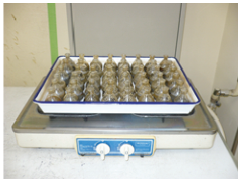
写真-1 湯せんによる煮沸の試験状況
