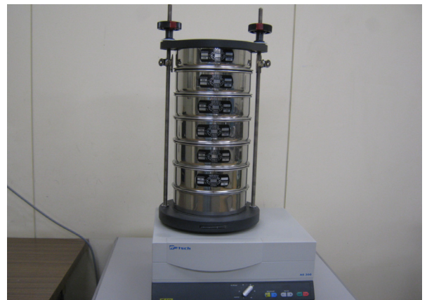
図-3 電磁式の自動ふるい装置（電磁法） ((株)レッチェ製 AS-200)
