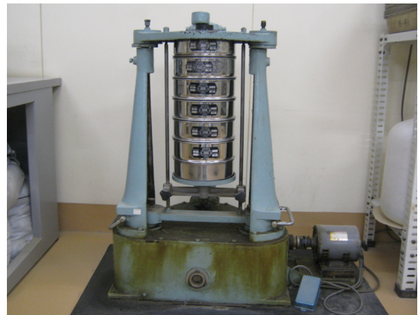
図-2 電動式ロータップ型自動ふるい装置（従来法） ((株)マルイ製 MIC-113-0-01)
