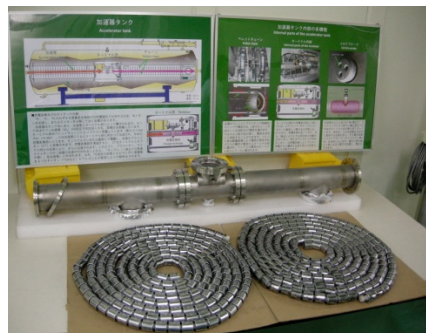
p-5 ペレットチェーン (電荷を運ぶベルトの役割を果たす)
