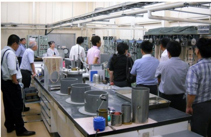
写真-14 力学試験の見学風景(ペDESTALを揃えた三軸試験機)
