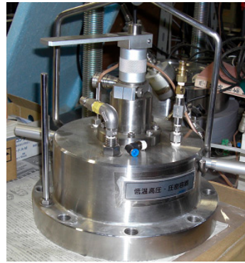
低温・高圧圧密試験器装置 (現在予算獲得し易い) (メタンハイドレート(深海底)用 圧密試験装置)
