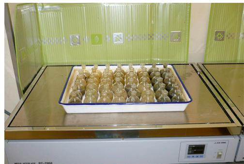
図-4 ホットプレートによる煮沸状況
