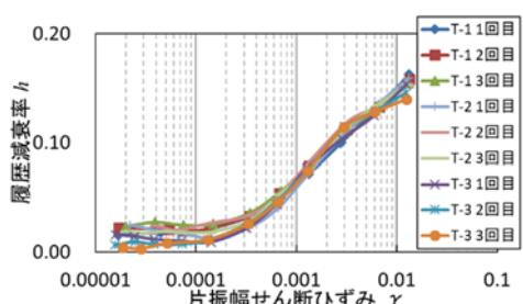
図4 全試料の履歴減衰率  $h$
