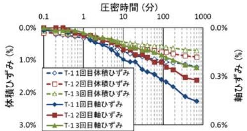
図 6 T-1 の体積ひずみと軸ひずみ
