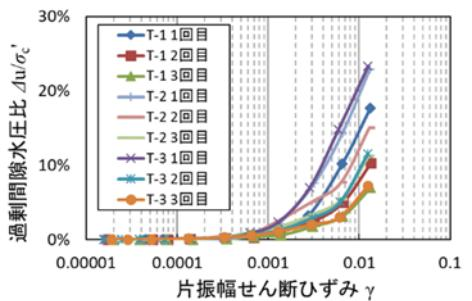
図 5 全試料の過剰間隙水圧発生状況
