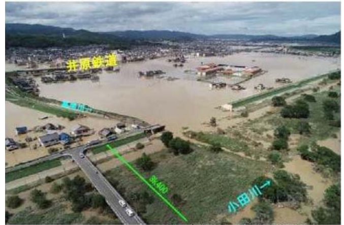
倉敷市真備町の破堤・浸水状況 (引用元: 中国地整 HP)
