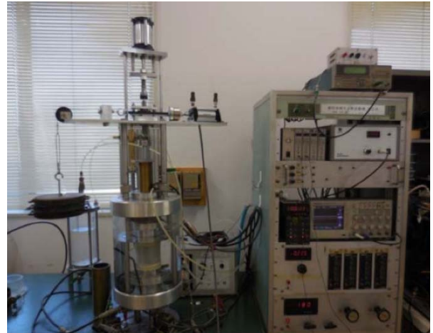
間隙水圧制御可能な中空ねじり試験装置
