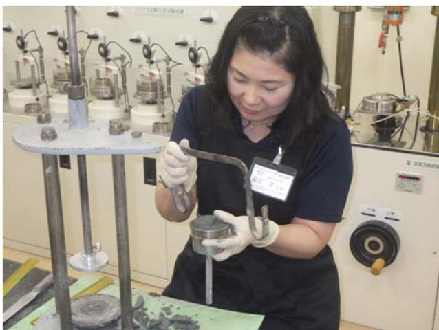
一軸・圧密コースの実習（圧密供試体作製）状況
