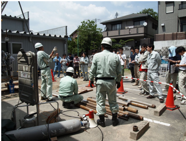
写真-5 ボーリング+孔内水平載荷試験見学状況
