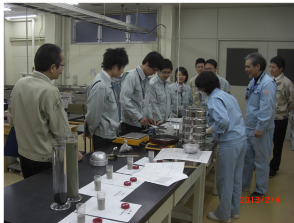
液性限界試験実習状況
